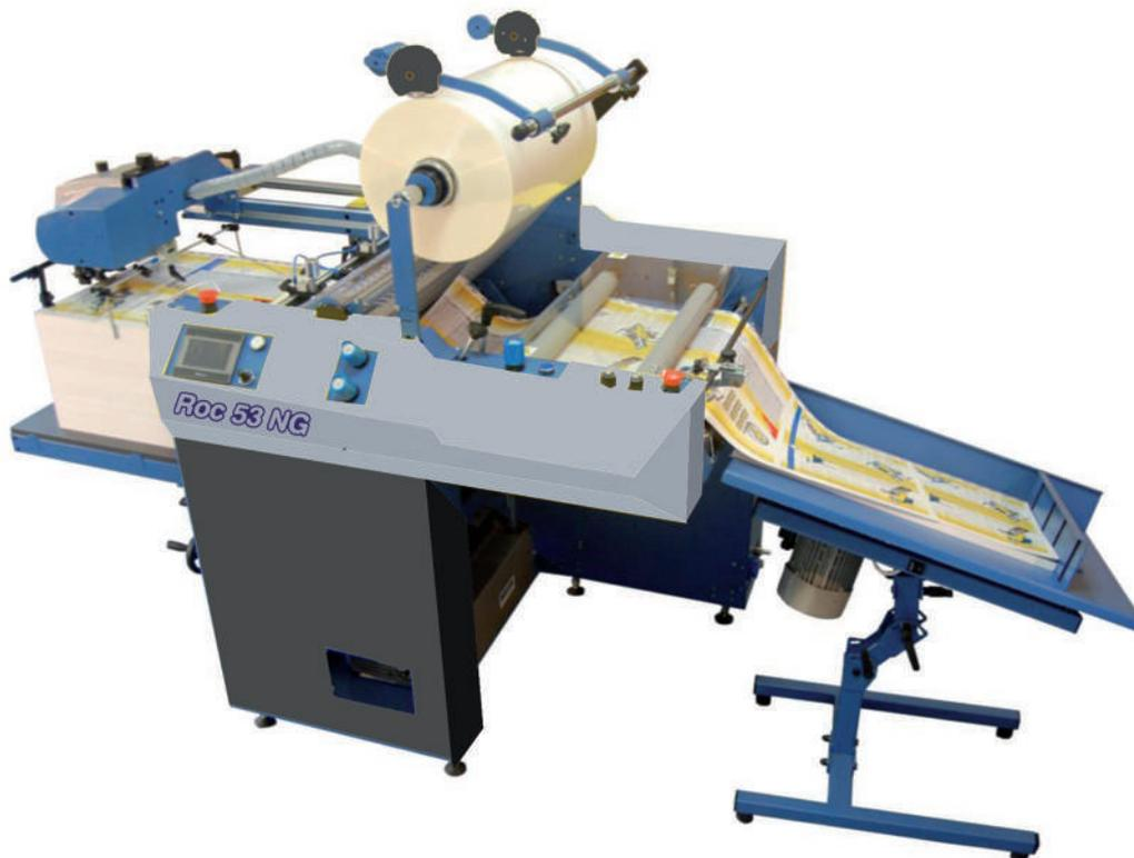
La laminadora Roc es una laminadora industrial muy compacta, pensada para offset y digital, con un alimentador Heidelberg de succión integrado y un separador de alta velocidad.
